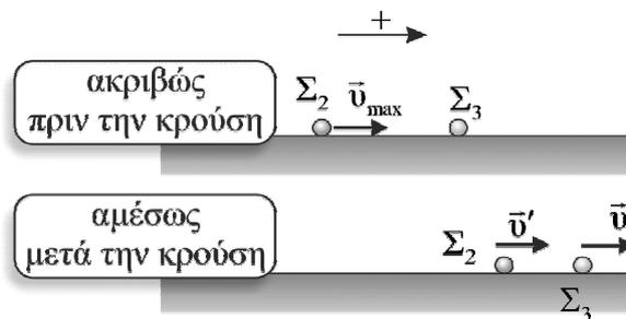
$$\vec{p}_{ολ(πριν)} = \vec{p}_{ολ(μετά)} \text{ ή } m_2 \cdot v_{\max} + 0 = m_2 \cdot v' + m_3 \cdot v_3 \xrightarrow{(1)} v' = 0$$
