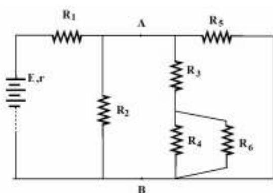
Οι  $R_{4,6}$  και  $R_3$  είναι συνδεδεμένες σε σειρά:  $R_{3,4,6} = R_{4,6} + R_3 = 6 + 2 = 8\Omega$
